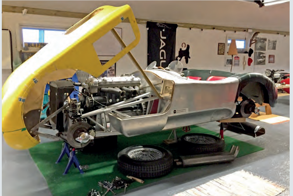
Frå restaurering av replika-bilen i Skien. Største utfordringa var å tilpasse front og bakstykke i glasfiber til senterseksjonen av aluminium.
