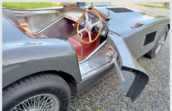
På ein C-type er det berre sjåføren som har dør. Mest sannsynleg laga for hurtig ombordstigning ved starten av Le Mans. Legg også merke til reservepluggane i døroppinga.
