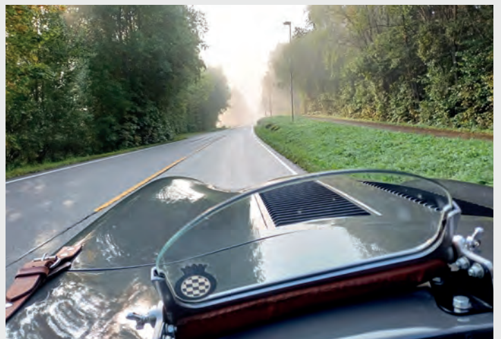
Bilen har ikkje frontrute, men veldig tidsrette såkalla Brooklands-ruter som til ein viss grad dempar vinden i fjeset.
