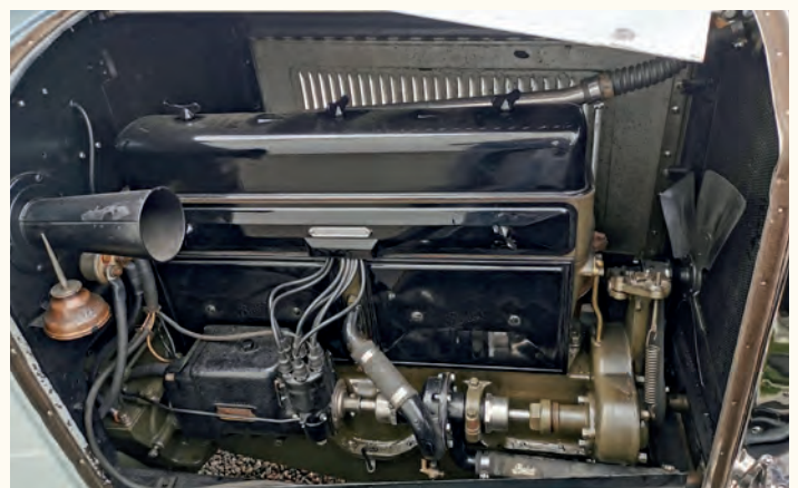
Motoren er på 331 cu in (5.4 L) og utvikler 70hk, og var ny for året. Ett av de største salgsgargumentene var hvor lett denne var å vedlikeholde, samt slitestyrken. Legg også merke til smørekanna som er plassert på torpedoen, ment for å gi dynastarteren (starter og dynamo i ett) noen dråper i ny og ned. Motoren er overhelt i Norge og fungerer meget bra!
