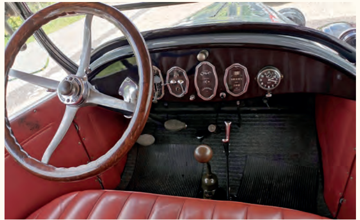
En hyggelig arbeidsplass for en skyss-sjåfør på 1920-tallet, og en fin plass å nyte varme sommerdager i 2023. Når man ser på ratt og instrumenter, er det ikke tvil om at Buick ville satse på eleganse. Legg også merke til at dashbordbelysning er plassert over oljetrykksmåleren og spenningsmåleren, så speedometeret var nok ikke i hovedfokus den gang. Ellers er det normal pedalfunksjon, sett opp i mot den samtidige T-Forden som hadde giring på pedalene og håndgass.
